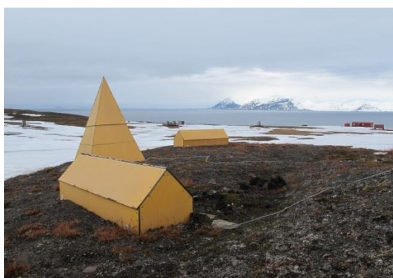
Kassene inneholder induksjonsgivere som måler magnetiske kraftfelt
