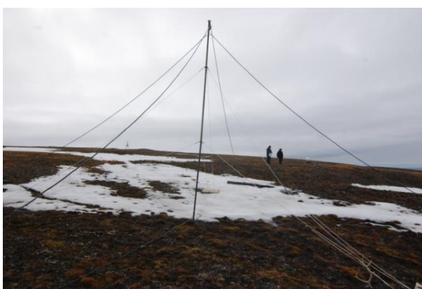
Antenne for mottak av ekstra lavfrekvente bølgebånd
